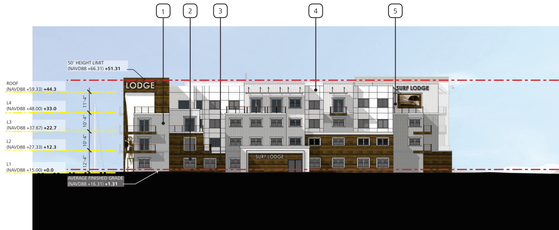
1. NORTH ELEVATION *NOTE: L1 F.G & F.F.E. = +15.00 NAVD88
